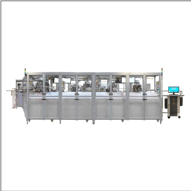
Flexible, vollautomatische Verarbeitungsmaschine für das Anschlagen von RAST-Steckverbindern in Schneidklemmtechnik (SKT), zur Fertigung von Busleitungen (Daisy Chain), für vielfältige Kabelbaumkonfigurationen, auf die Anwendungsbedürfnisse anzupassende Maschine
